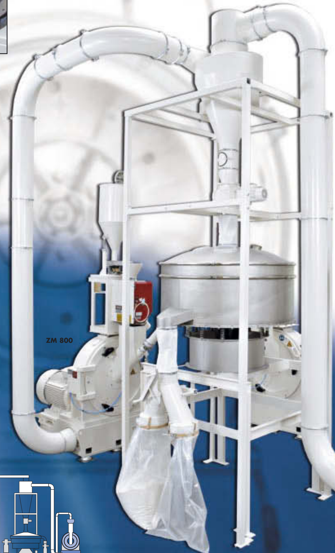
Installation de micronisation avec dispositif de dépoussiérage et retraitement
